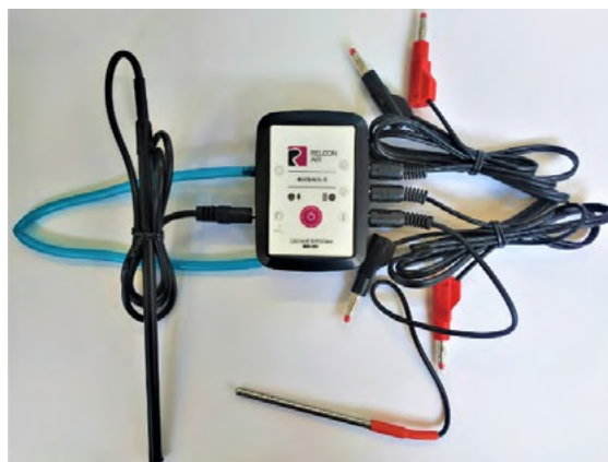
Рис. 9. Беспроводной мультидатчик Releon Air «Физика-5»
